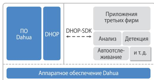
Dahua Open Platform (DHOP) – это открытая платформа, которая позволяет загружать и устанавливать приложения третьих фирм на сетевые видеокамеры Dahua.
